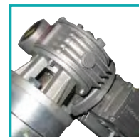
Motor s pužnim transporterom za dobavu peleta
